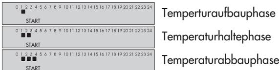
Erlischt die Zusatzanzeige im Bild der Vorlauf-temperaturanzeige nach der letzten Phase, ist die Estrich Trocknung vollständig abgelaufen. Jede Netzunterbrechung während des Verlaufs der Funktion führt zum automatischen Neubeginn der Estrich Trocknung.
